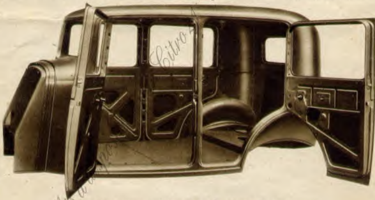
Carcasse d'une carrosserie " Tout Acier Monopiece ". On remarque la solide structure des panneaux et montants entièrement métalliques.
