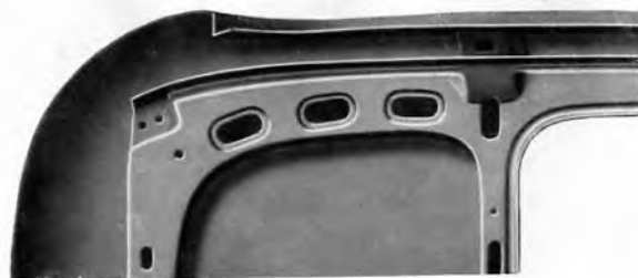
Vue du panneau de côté et des renforts.
