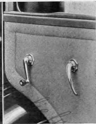
A gauche : poignée de lève-glace. A droite : poignée intérieure de porte.
