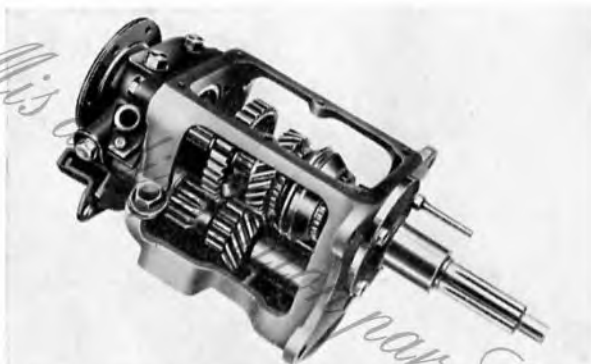
Vue intérieure de la boîte de vitesses à engagement synchronisé et deuxième silencieuse.
