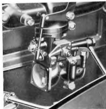
VUE DU CARBURATEUR SOLEX VERTICAL A STARTER
